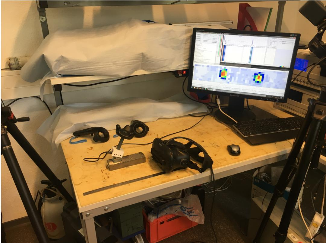
Abbildung 6.5: Versuchsaufbau für die Erstellung eines C-Scans mit der erstellten Anwendung
