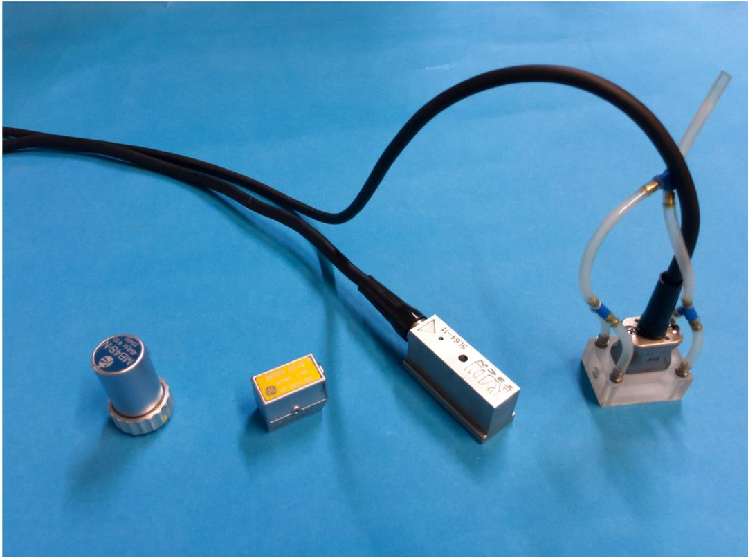
Abbildung 2.2: Verschiedene Prüfköpfe (PK) (von links): PK mit runder Schwingfläche, PK mit festem Winkel, Linearer Phased-Array-PK, Linearer Phased-Array-PK mit Wasserleitungen und Vorlaufkeil.
