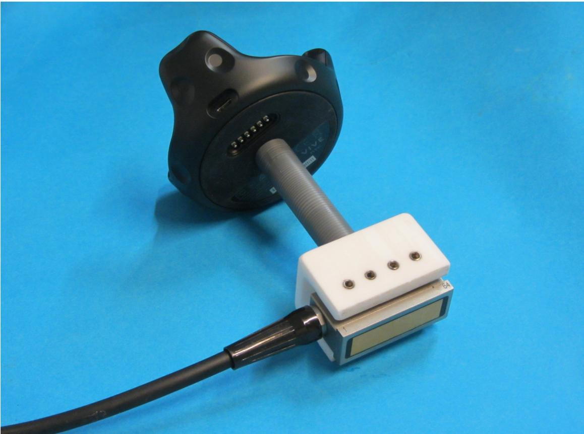
Abbildung 5.1: Am Tracker befestigte Prüfkopfhalterung mit eingespanntem Phased-Array-Prüfkopf (auf der Seite liegend).
