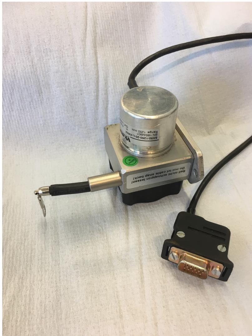
Abbildung 2.8: Seilzugencoder, welcher für die Erstellung von C-Bildern genutzt wird
